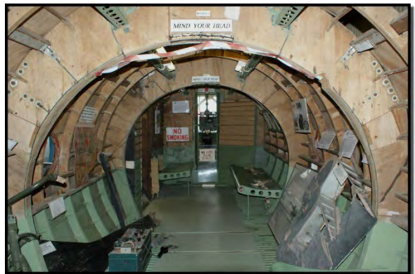
Een Horsa Glider zweefvliegtuig van de binnenkant (hout)
