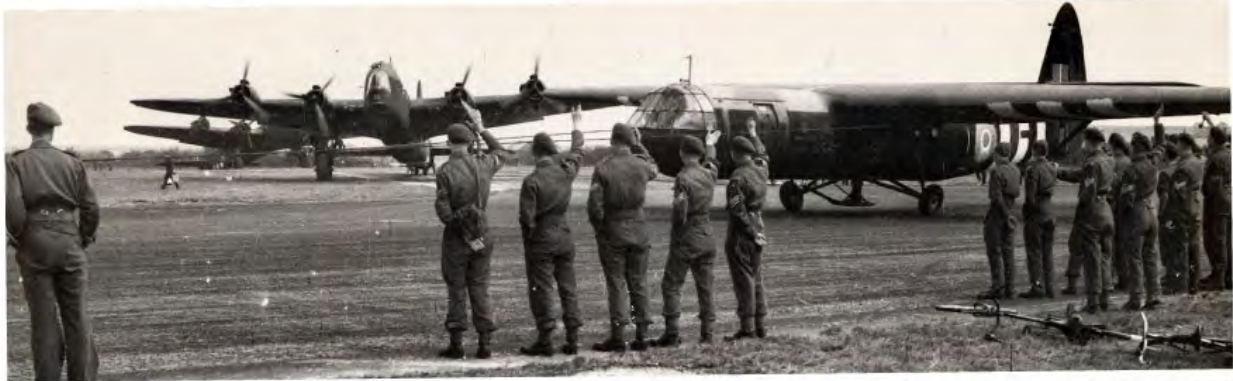
Short Stirling Mark IV bommenwerpers staan klaar op RAF Harwell om de volgende Horsa 1 naar Nederland te slepen. Bij deze gliders zaten de sleepkabels aan het bovenste bevestigingspunt van het hoofdlandingsgestel aan de vleugels, bij de Horsa 2 aan het neuswiel.
